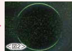
<図2> 周波数を高くすることにより、表面傷の検出能力が高くなる
